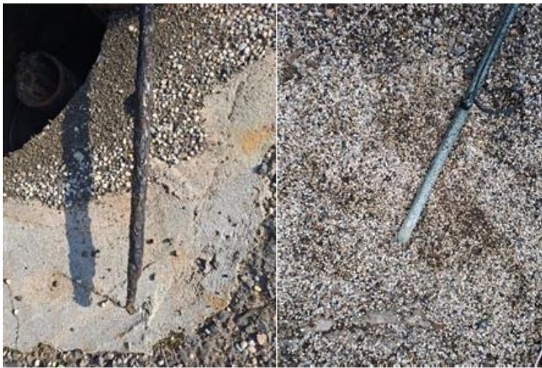
Obr. 4: Degradovaná anoda a katoda s inkrustací
