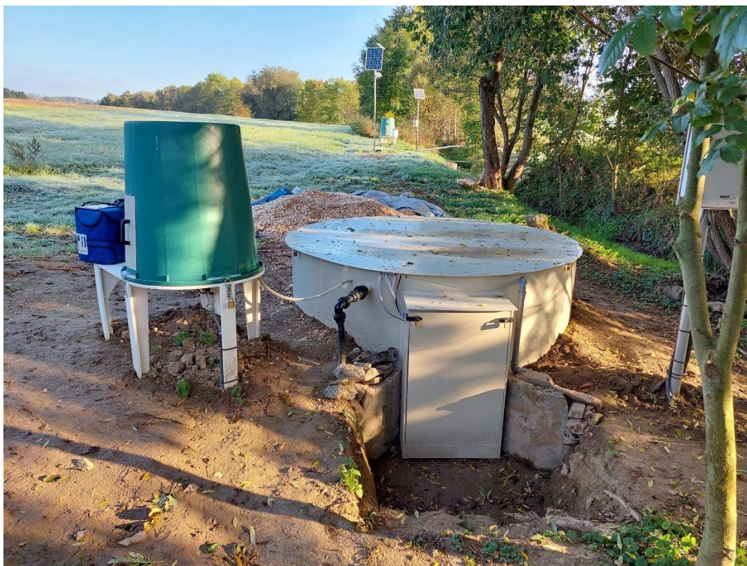
Obr. 3: Poloprovodní jednotka štěpkového denitrifikačního bioreaktoru určená k souběžnému odstraňování dusičnanů a pesticidů
