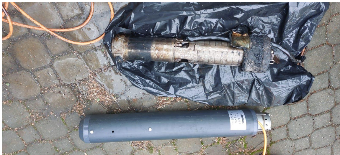
Obr. 5: Výsledek značné agresivity DNAPL – čerpadlo nové a po 1 týdnu čerpání
