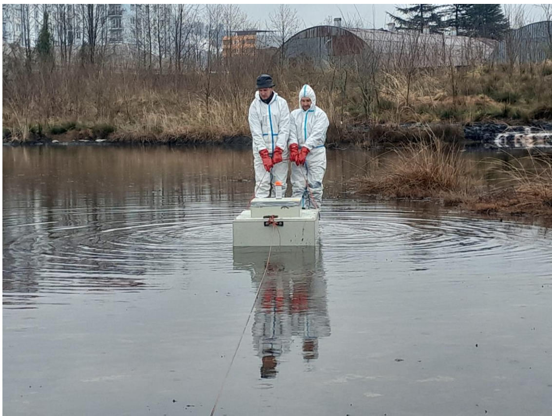
Obr. 3: Geofyzikální měření na ropných lagunách pomocí georadaru
